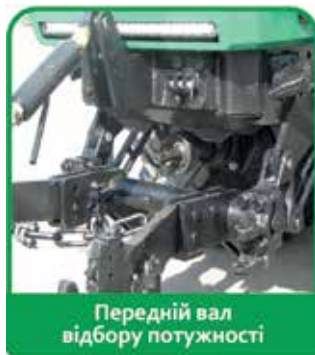
Передній навісний пристрій з захватами категорії 3
