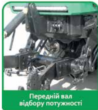
Передній навісний пристрій з захватами категорії 3
