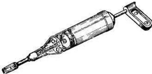
Рис. 7.1.2. Шприц для подачі консистентного змащення в кулькові прес-масельнички
