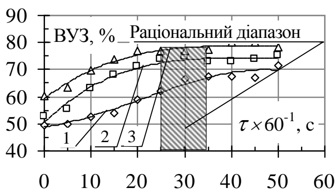
Рис. 3.10. Залежність ВУЗ від тривалості дозрівання білкової основи за концентрації натрію двовуглекислого 0,4 % та цитрату натрію, %: 1 – 1,0; 2 – 2,0; 3 – 3,0
