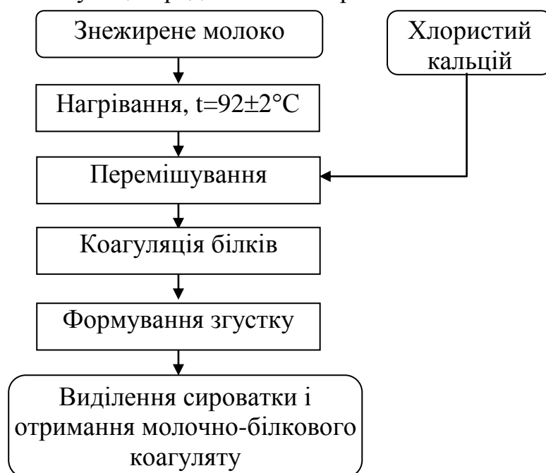
Рис. 2.7 Принципова схема виділення молочного білка на основі термокальцієвої коагуляції
