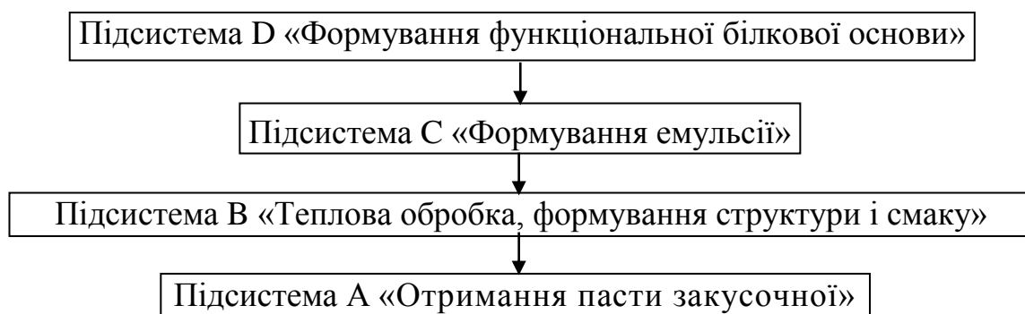
Рис. 4.1 Модель технологічної схеми виробництва паст закусочних
