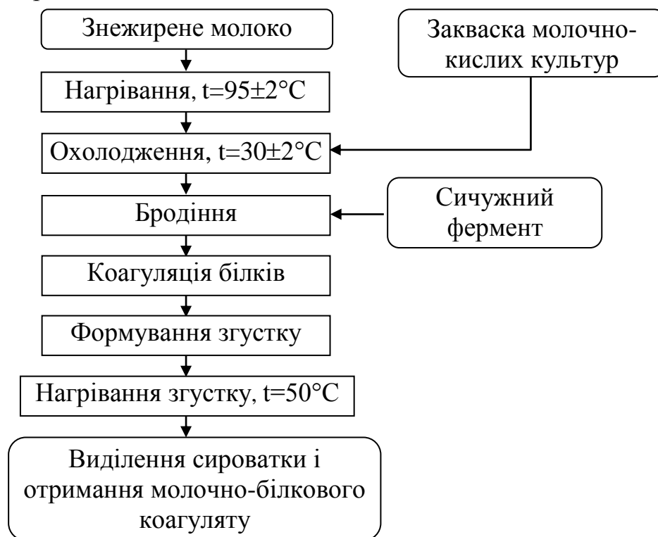
Рис. 2.6 Принципова схема виділення молочного білка на основі сичужно-кислотної коагуляції
