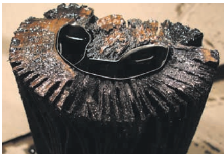
Рис.2. Деформований фільтрувальний елемент із зірваним бандажем. Добре видно сліди неякісного приклеювання
