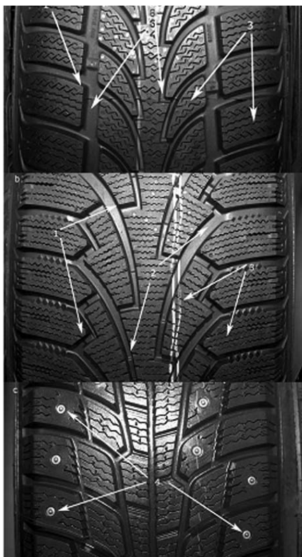
Типи виконання протектора зимових шин: а — європейський, б — скандинавський нешипований, с — скандинавський шипований. Основні частини протектора: 1 — «шашки»; 2 — канавки; 3 — ламелі; 4 — шипи
