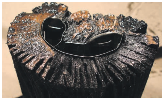
Рис.2. Деформований фільтрувальний елемент із зірваним бандажем. Добре видно сліди неякісного приклеювання
