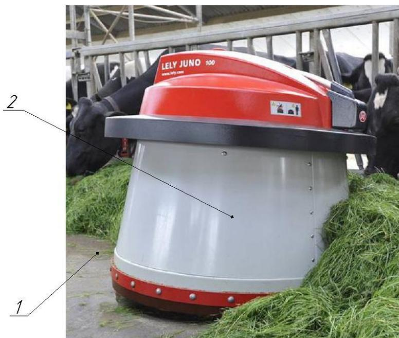
1 – кормовой стол; 2 – роботизированный пододвигатель
