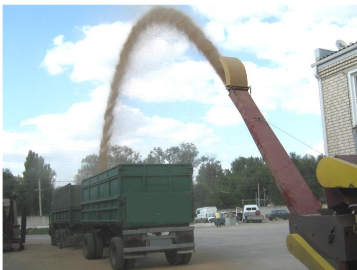
Рис. 8 – Рух зерна при завантаженні зернокидачем
