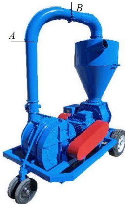
Рис. 6 – Пневмотранспортер з криволінійною ділянкою AB
