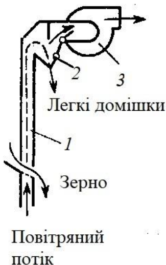
Рис. 12. – Поділення за аеродинамічним коефіцієнтом: 1 – канал; 2 – осаджувальна камера; 3 – вентилятор
