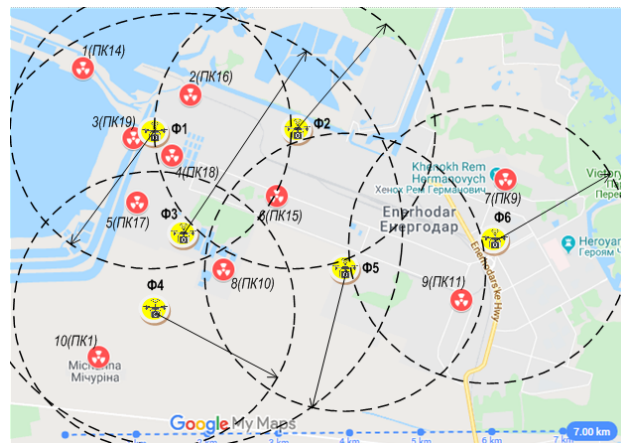
Рис. 2. Пости контролю АСКРО Запорізької АЕС, флоти БПЛА, зони їх спостереження та радіуси дії. Варіант 2.
