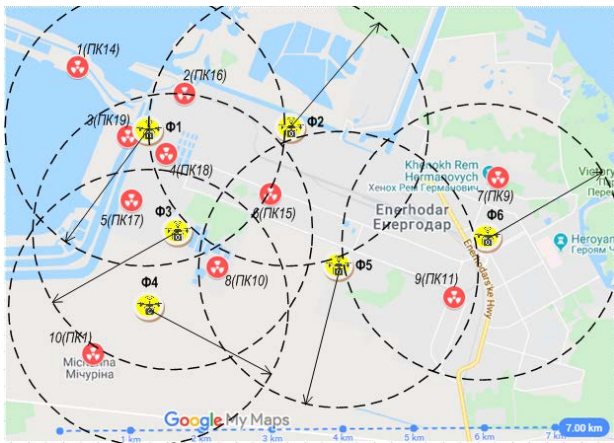
Рис. 1. Пости контролю АСКРО Запорізької АЕС, флоти БПЛА, зони їх спостереження та радіуси дії. Варіант 1.
