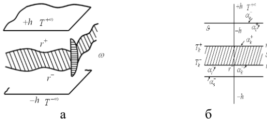
Рис. 1. Схема теплообміну для течії бінгамівської рідини в каналі, який занурено в тепловий резервуар: а – вигляд в об'ємному розмірі; б – схема течії та характеристик теплообміну з тепловим резервуаром
