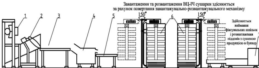
Рисунок 4.5 – Технологічна схема міні-лінії з виробництва різаних сушених плодово-ягідних напівфабрикатів: 1 – контейнероперекидач; 2 – машина мийна конвеєрна; 3 – інспектуючий стіл; 4 – машина для нарізання плодово-ягідної сировини; 5 – завантажувальний стіл із сітчастими піддонами; 6 – вертикальна циліндрична ІЧ-сушарка (ВЦ ІЧ-20); 7 – приймальний стіл фасувально-пакувального автомата
