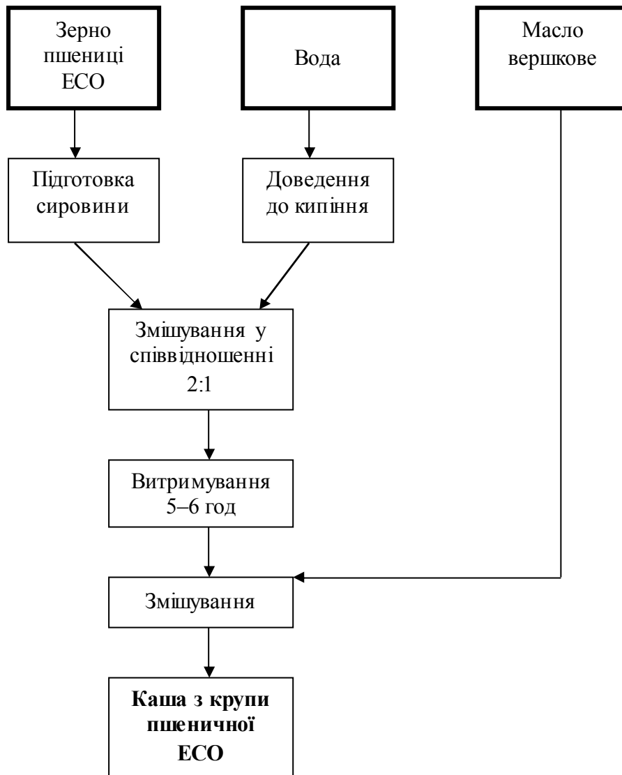
Рисунок 4.49 – Технологічна схема виробництва каші з крупи пшеничної ЕСО
