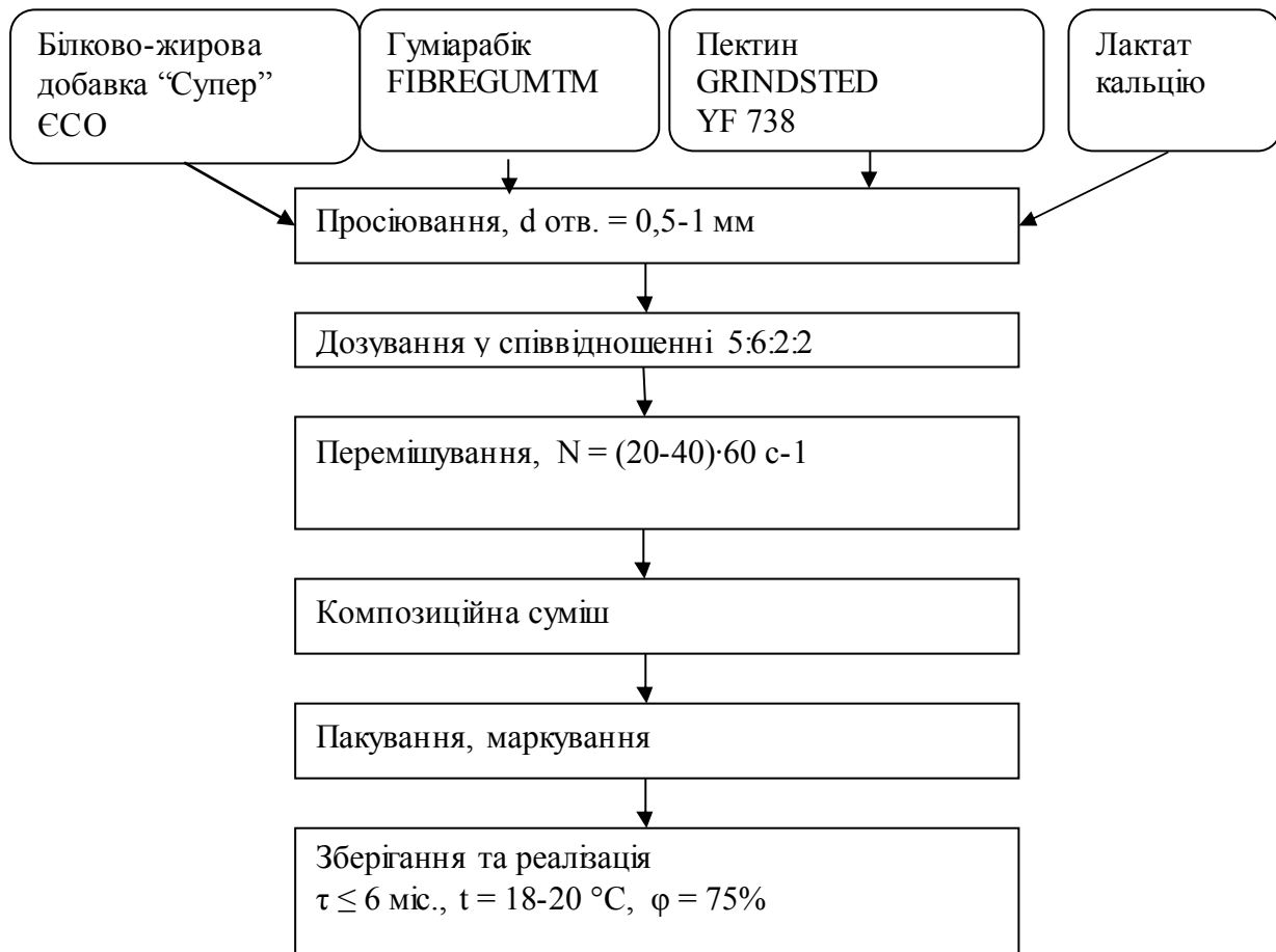
Рисунок 4.203 – Технологічна схема виробництва композиційної суміші
