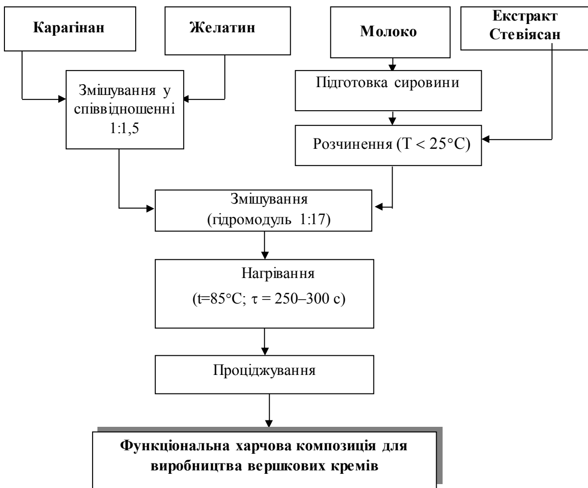
Рисунок 4.137 – Технологічна схема виробництва функціональної харчової композиції з екстрактом Стевіясан та карагінаном для вершкових кремів
