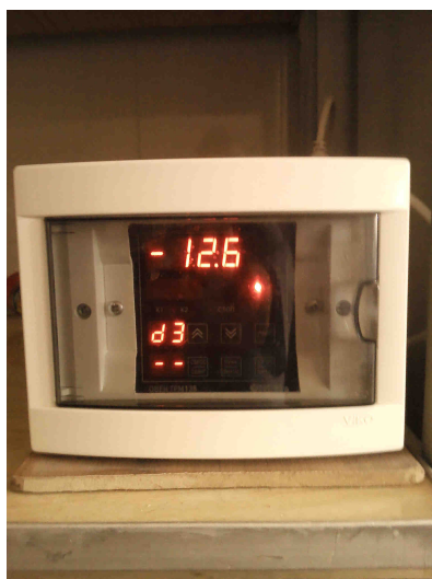
Рисунок 2.2 – Загальний вигляд вимірювача-регулятора багатфункціонального восьмиканального ОВЕН ТРМ 138-Р із автоматичним перетворювачем інтерфейсів ОВЕН АС 4
