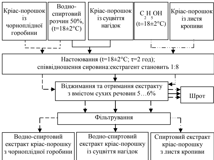
Рисунок 2.5 – Технологічна схема екстракції дрібнодисперсних кріас-порошків із антоціанової, каротиновмісної та хлорофіловмісної рослинної сировини
