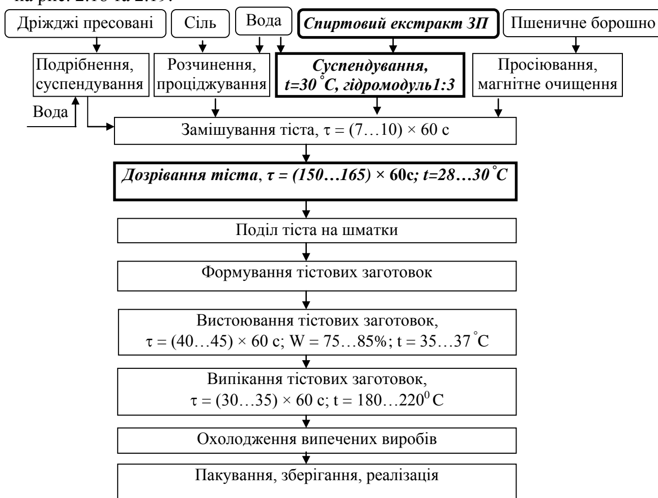
Рисунок 2.18 – Технологічна схема виробництва хліба «Духмяний» безопарним способом з додаванням спиртового екстракту ЗП
