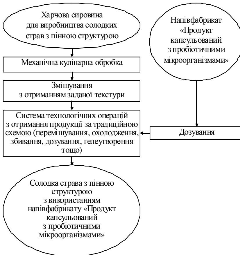
Рисунок 4.2 –Принципова технологічна схема виробництва солодких страв з пінною структурою з використанням напівфабрикату «Продукт капсульований з пробіотичними мікроорганізмами»
