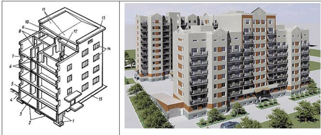
Рис. 2.10 Конструктивна схема безкаркасної багатоповерхової будівлі
