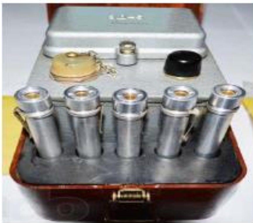
Рисунок 7.13 – Комплект вимірювачів дози ДП-24
