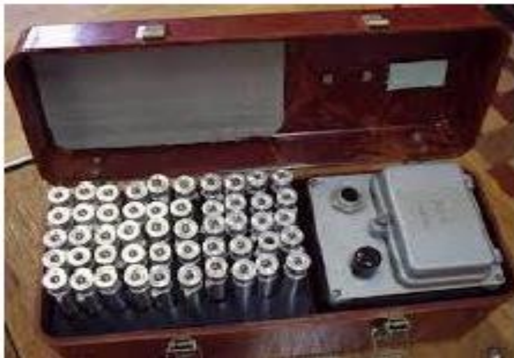
Рисунок 7.14 – Комплект вимірювачів дози ДП-22
