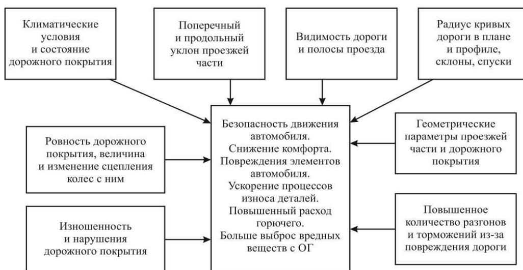
Рис.1 – Основные параметры дорожных условий, влияющие на безопасность и техническое состояние автомобилей
