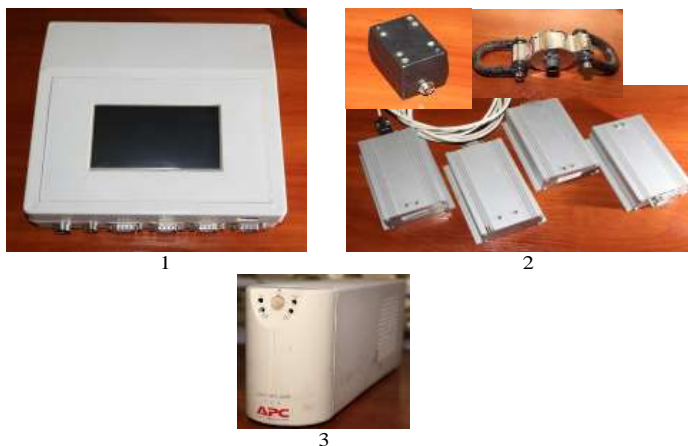
Рис.4.5 – Загальний вид вимірювальної системи та датчиків: 1 – обчислювальний модуль; 2 – датчики; 3 – блок живлення
