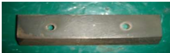
Рис. 4.14 – Зразки для проведення досліджень на зношування в абразивному середовищі: а – схема зразку різального елемента; б – загальний вид зразку різального елемента лапи
