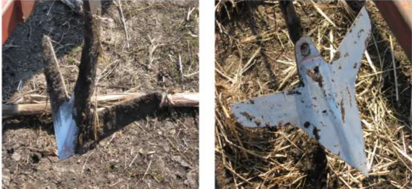
Рис. 4.27 – Визначення залипання культиваторних лап ґрунтом: а) стандартна; б) експериментальна
