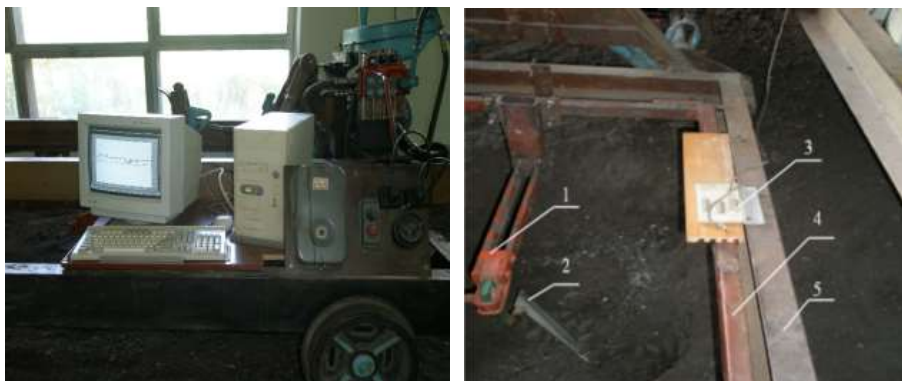
Рис. 4.15 – Засоби фіксації та вимірювань тягового опору фрагментів культиваторних лап: 1 – гряділь; 2 – досліджуваний робочий орган; 3 – датчик фіксації лінійних переміщень; 4 – рухома рама; 5 – націпна нерухома рама
