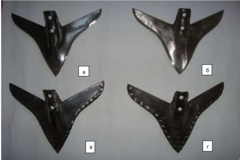
Рис. 5.33 – Експериментальні культиваторні лапи: а – монометалеві з криволінійною формою леза; б – експериментальні з нижнім локальним зміцненням леза; в, г – експериментальні з верхнім локальним зміцнення леза
