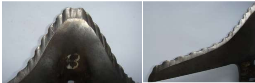
Рис. 5.44 – Загальний вид локального зміцненого леза експериментальних лап при зношуванні: а – носова частина лапи; б – лезо лапи культиватора при зношуванні
