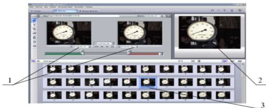
Рис. 4.22 – Робоче вікно програми для визначення тягового опору культиваторних лап у польових умовах: 1 – лічильник кадрів; 2 – визначення тягового опору в реальному часі; 3 – фрагменти порівняльних випробувань серійних та експериментальних лап при відповідній глибині та швидкості руху агрегату
