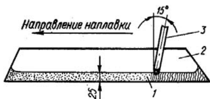
Рис. 4. Схема электродуговой наплавки лезвия лемеха порошкообразным твердым сплавом: 1 — шихта; 2 — лемех; 3 — графитный электрод
