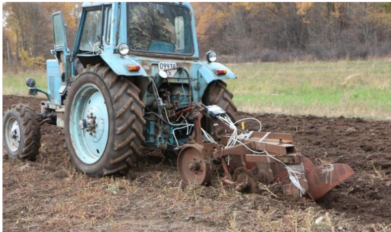
Рис. 6. Загальний вигляд вимірювальної системи з датчиками, встановленими на тракторі МТЗ-82 і начіпному лемішному плугі ПЛН-3-35
