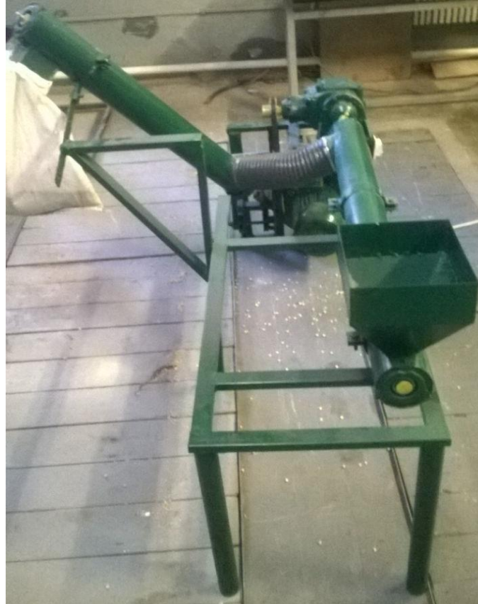
Рис. 1 – Загальний вигляд станда гвинтового завантажувача
