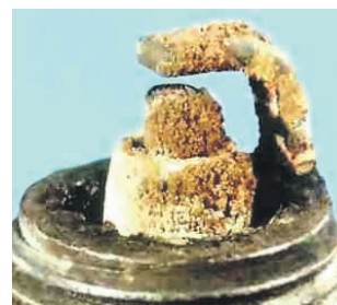
Рис. 4. Толстый слой рыхлых отложений.
