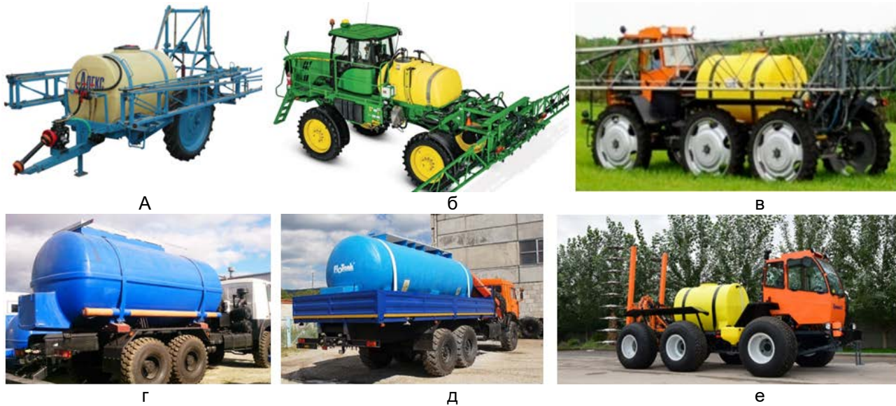
Рис. 1. Мобільні технологічні машини з баками, що приєднані бандажами а – причіпний обприскувач польовий малооб'ємний штанговий «Алекс»; б – самохідний обприскувач John Deere R4030; в – самохідний обприскувач Туман 2 на вузьких колесах; г – склопластикові автоцистерни для транспортування будь-яких рідин в т.ч. агресивних; д – автоцистерна для води і молока від компанії «Флотенк»; е – мультиінжектор на базі Туман 2
