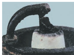
Рис. 6. Оплавление центрального электрода.
