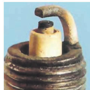
Рис. 1. Светло-коричневый нагар. Нормальная работа свечи.
