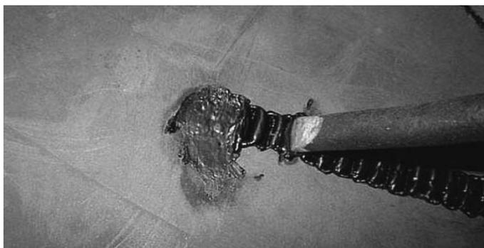
Скобы располагаем перпендикулярно шву на расстоянии 1-2 см по всей длине разлома. Едва намечающиеся трещины и ответвления тоже сплавляем. Иначе в дальнейшем от вибрации они перерезаются.
