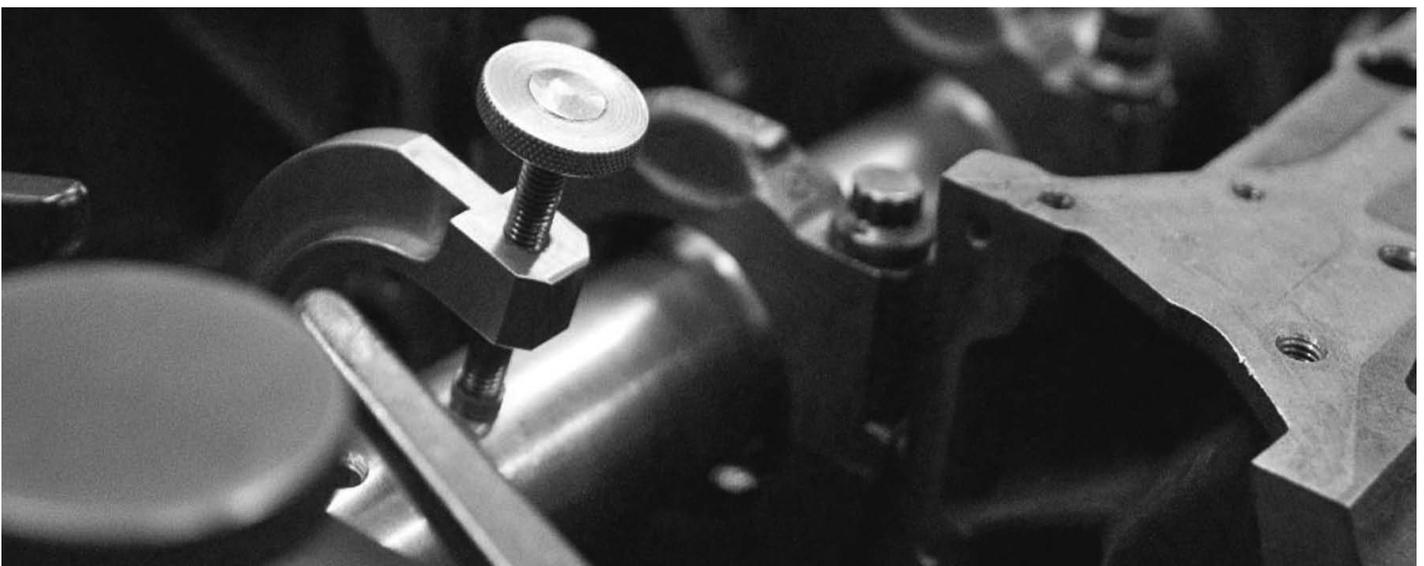
хонинговальном станке необходимы два шарнира, чтобы устранить возможную несоосность шпинделя станка и отверстия. Обработка опор подшипников в блоках цилиндров и головках выполняется на горизонтально-хонинговальных станках, где также требуются два шарнира между шпинделем станка и головкой.
