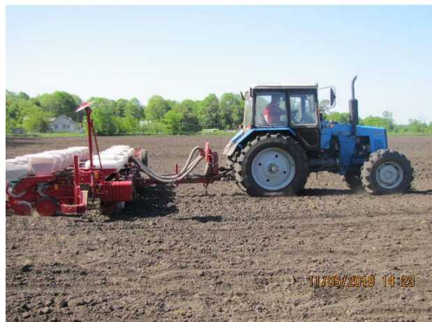
Рис. 2. Агрегат для сумісних посівів кукурудзи та сої в складі трактора «Беларусь 1221.2.» та сівалки на базі «Vega-8 Profi»
