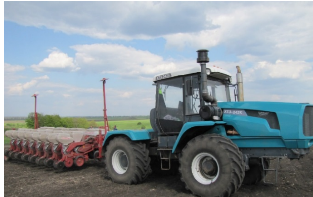
Рис. 1. Агрегат для сумісних посівів кукурудзи та сої в складі трактора ХТЗ-242К та дослідного зразка спеціалізованої сівалки на базі «Vega-8 Profi»
