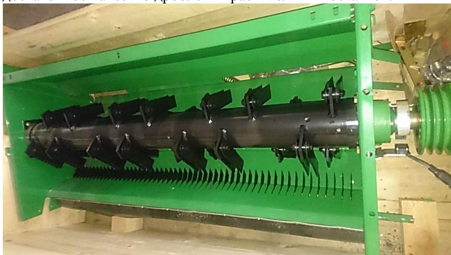
Рисунок 1 – Узел соломорезки с ножевым ротором
