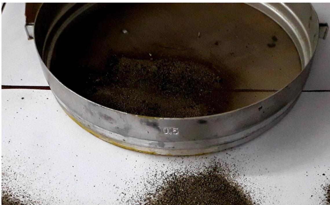
Рис. 2. Определение дисперсного состава лёгких примесей и пыли с помощью набора лабораторных решет с размером 25мкм, 50мкм и 75мкм
