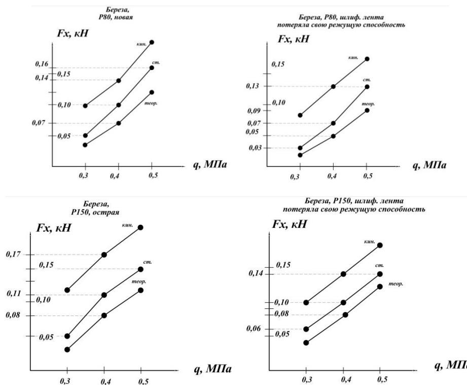
Рис. 4. Залежність впливу зернистості шліфувальної шкурки і удельного тиску на касательну складову сили резання при шліфуванні деревини берези
