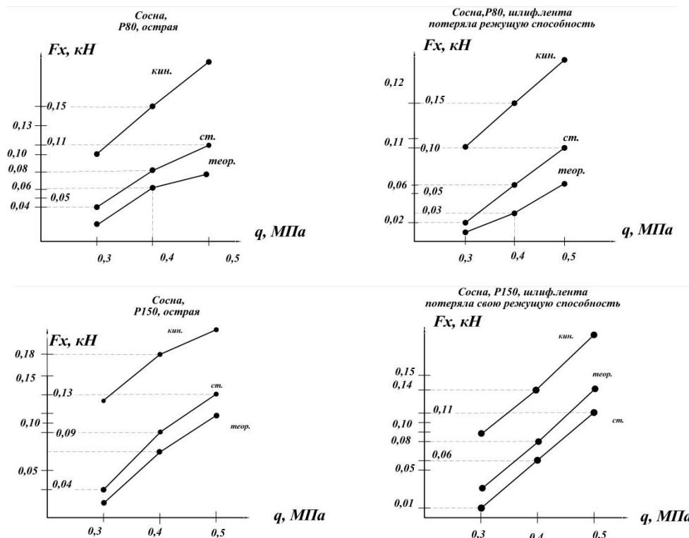
Рис. 3. Залежність впливу зернистості шліфувальної шкурки і удельного тиску на касательну складову сили резання при шліфуванні деревини сосни
