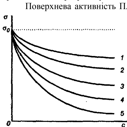
Рисунок 15.3 – Ізотерми поверхневого натягу розчинів кислот: 1 – оцтової; 2 – пропіонової; 3 – масляної; 4 – валер'янової; 5 – капронової
