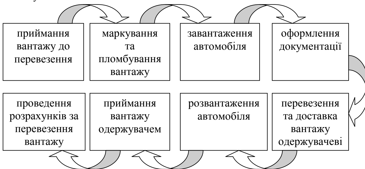
Рисунок 14.1 – Основні етапи технологічного процесу перевезення вантажів автомобільним транспортом
