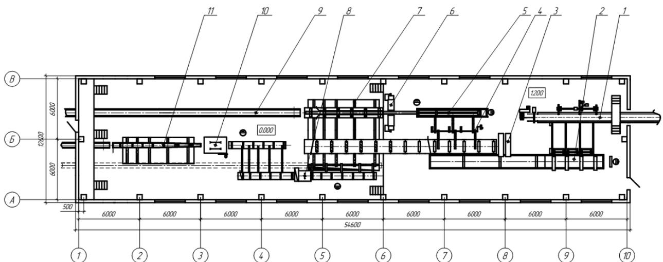
Рис. 5. Технологическая схема лесопильного потока для выпилки шпал: 1 – бревнотаска; 2 – зажимная тележка; 3 – ленточнопильный станок ЛЛК-2; 4 – брусоперекладчик; 5 – зажимающий и подающий механизм; 6 – ленточнопильная установка ЛБЛ-1; 7 – поперечный цепной конвейер; 8 – торцовочный станок ЦКБ 40-01; 9 – ленточный конвейер; 10 – обрезной станок Ц2Д-7А; 11 – рейкоотделительное устройство.
