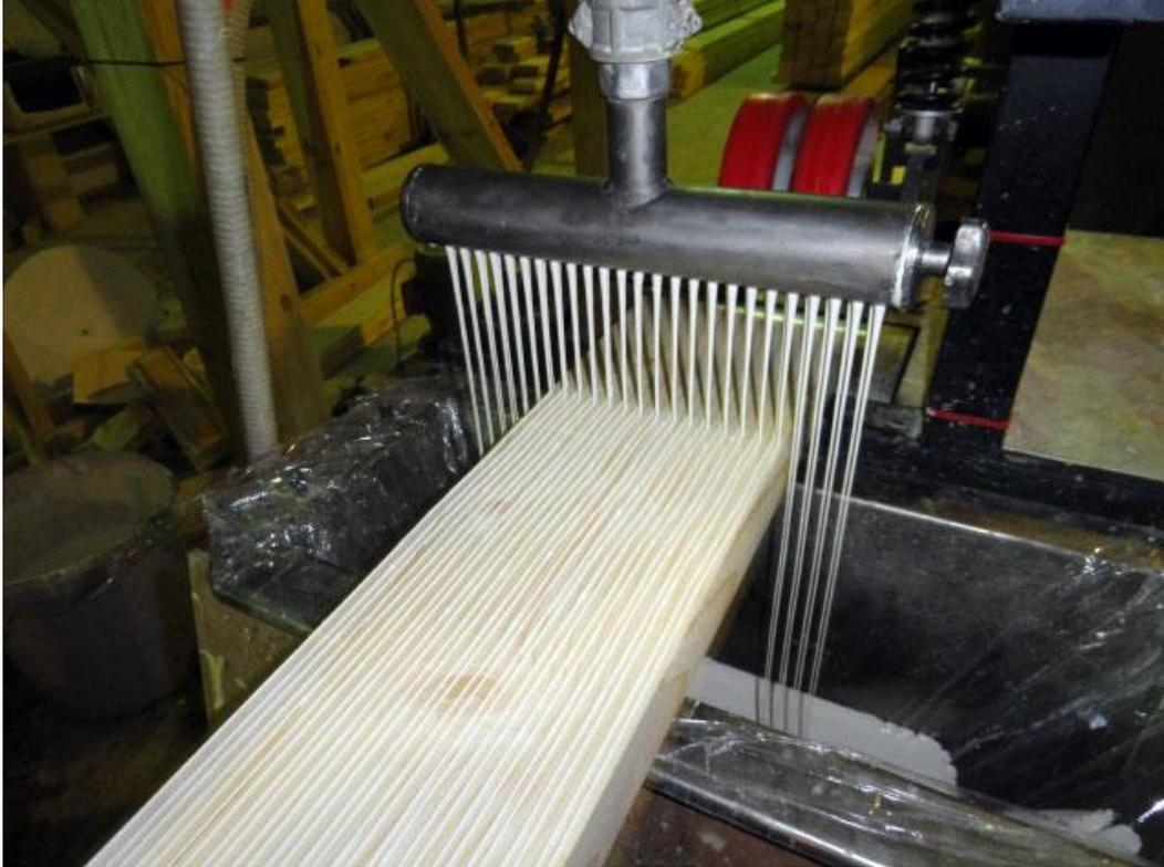
Рисунок 2 - Процесс нанесения клея в виде нитей.
