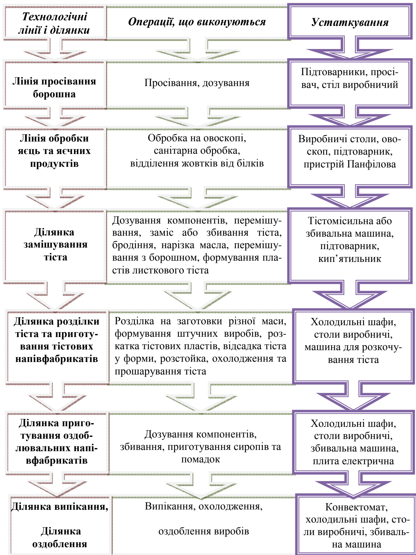
Рисунок 7.1 – Блок-схема технологічного процесу виробництва борошняних кондитерських виробів у кондитерському цеху
