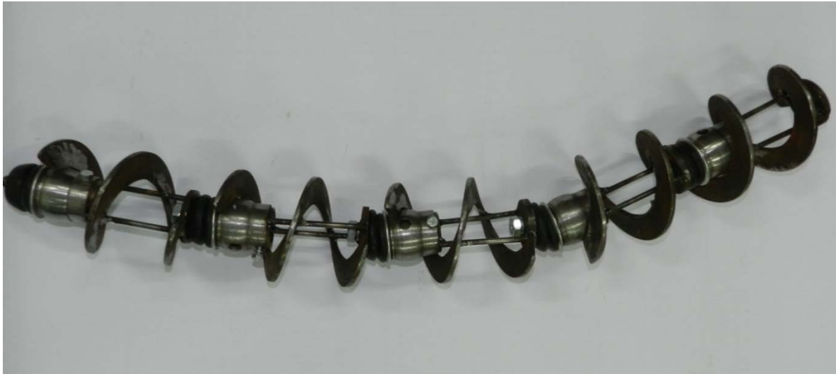
Рисунок 2 - Загальний вигляд експериментального секційно-шарнірного робочого органу гвинтового конвеєра
