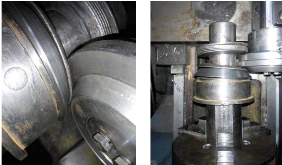
Рисунок 2 – Механізм для гнуття полицки на гвинтовій спіралі
