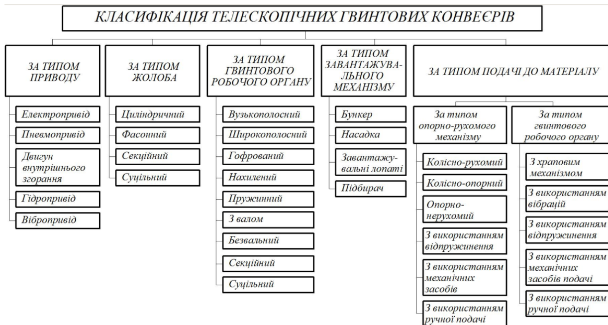
Рисунок 3 - Класифікація телескопічних гвинтових конвеєрів за конструктивними ознаками
