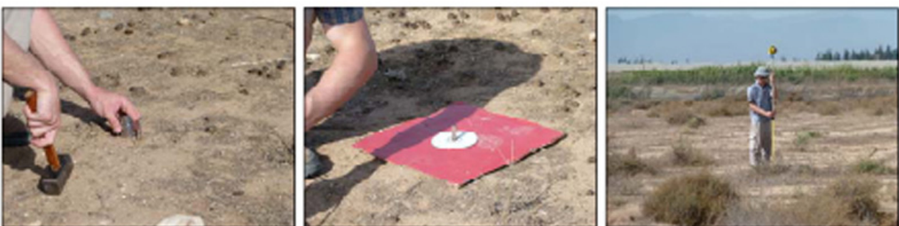
Рис. 1. Закладення реперів для аерофотозйомки ерозійних процесів [0]
