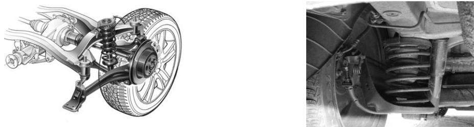
Рисунок 1 – Размещение пружин в конструкции подвески ходовой ТС
