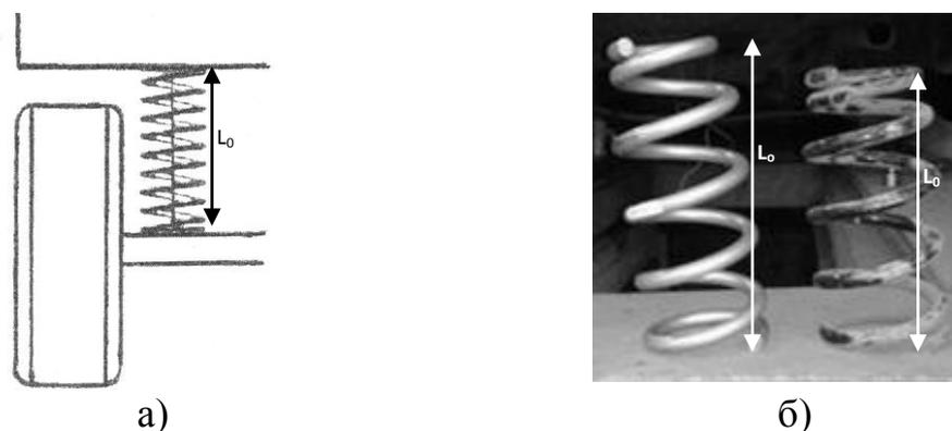
Рисунок 3 – Зона визуального контроля пружин подвески ТС:
