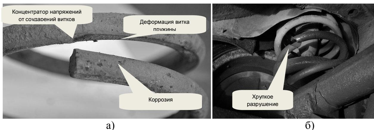
Рисунок 4 – Дефекты, выявленные при визуальном осмотре пружин подвески:
