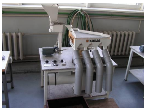
Рисунок 4 – Гравітаційний сепаратор: 1 - подаючий бункер; 2 - сортувальний стіл; 3 - лотки; 4 - ящики; 5 - приводний електромотор з ексцентриковою системою
