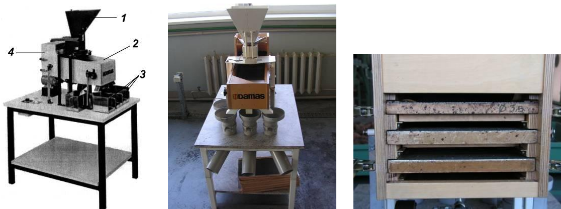
Рисунок 5 – Гратчастий сепаратор "Damas": 1 - бункер для насіння; 2 - система сит; 3 - збірки насіння; 4 - вібраційна система
