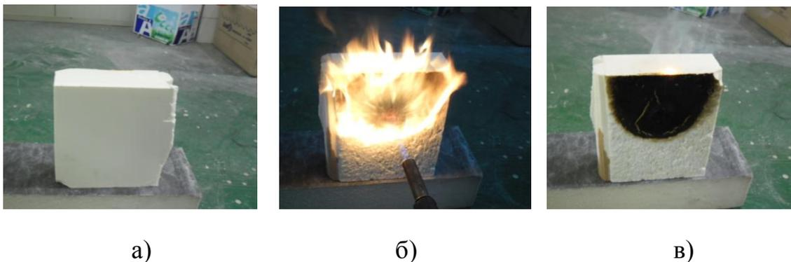
Рисунок 5 – Проведение эксперимента на пожаробезопасность пенополиизоцианурата: а) образец, б) обжиг, в) результат обжига.
