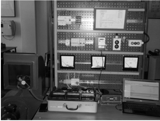
Рисунок 3 – Лабораторний стенд по дослідженню інтелектуальної енергозберігаючої системи керування регульованими електроприводами для вентиляційних установок з автоматичним підтриманням продуктивності всмоктування шкідливих речовин
