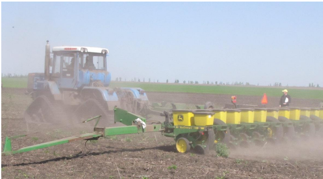
Рис. 5 – Трактор ХТЗ-280Т в агрегаті з просапною 12-рядковою сівалкою JohnDeer 7200
