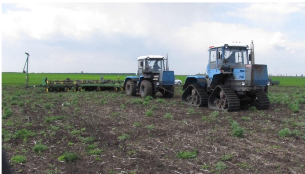
Рис. 3 – Дослідження роботи трактора ХТЗ-280Т по визначенню буксування
