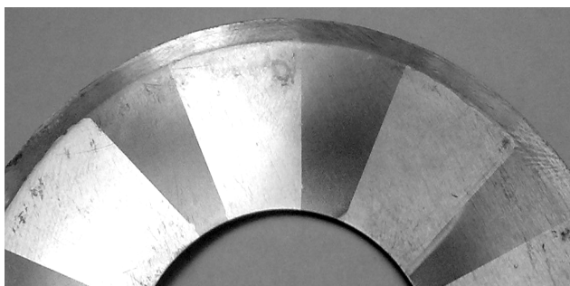
Рис.1. Режущий инструмент с ребрами жесткости
