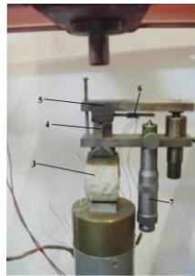
Рис. 2 – Елементи установи для визначення зусилля і деформації руйнування зерна:
