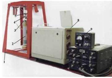
Рис. 1 – Установа для визначення зусилля і деформації руйнування зерна
