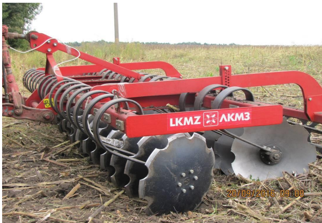
Рис. 1 – Борона «Дукат-4» з пружинними стійками кріплення дисків
